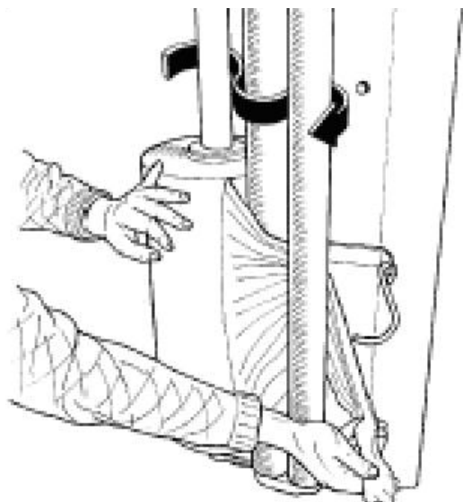
Fig. 6.3. Comment installer le film sur le distributeur
